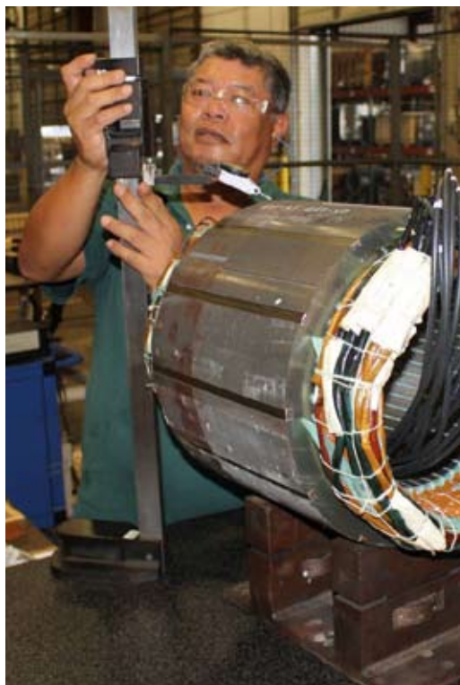
Empleados de TIC IZQUIERDA: inspeccionando el núcleo del estátor del motor. ARRIBA A LA DERECHA: armando una celda de voltaje mediana. ABAJO A LA DERECHA: probando variadores de velocidad.
